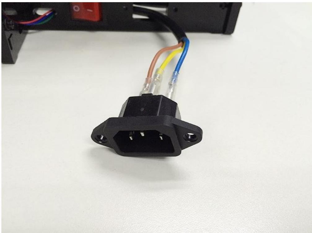
**Étape 2 :** Montez la prise en bas du panneau de droite à l'aide de 2 vis allen M3 x 16 hexagonales, les rondelles M3 et les écrous hexagonaux M3.
