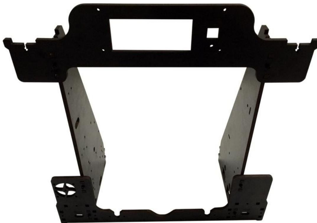
Notez l'orientation des trous du bouton de l'afficheur LCD. Le bouton de réglage est à droite.
