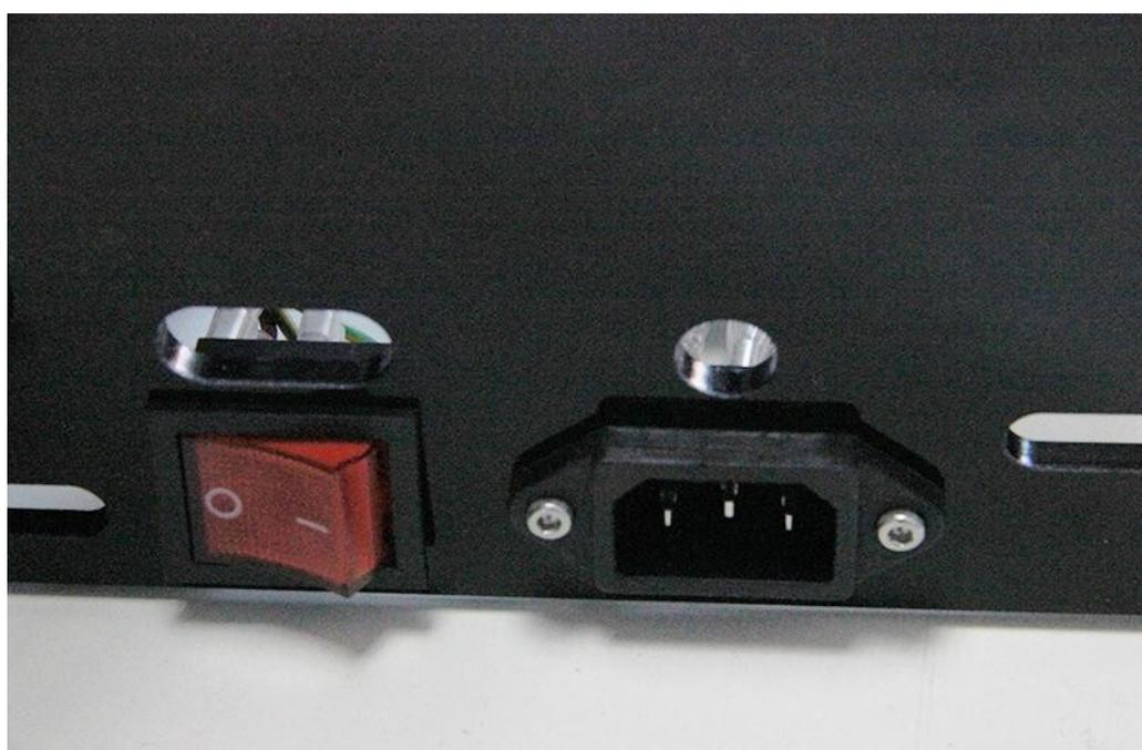
**Étape 3 :** Placez le câble de sortie d'alimentation en bas de l'imprimante, puis faites le passer par le trou du panneau de droite.
