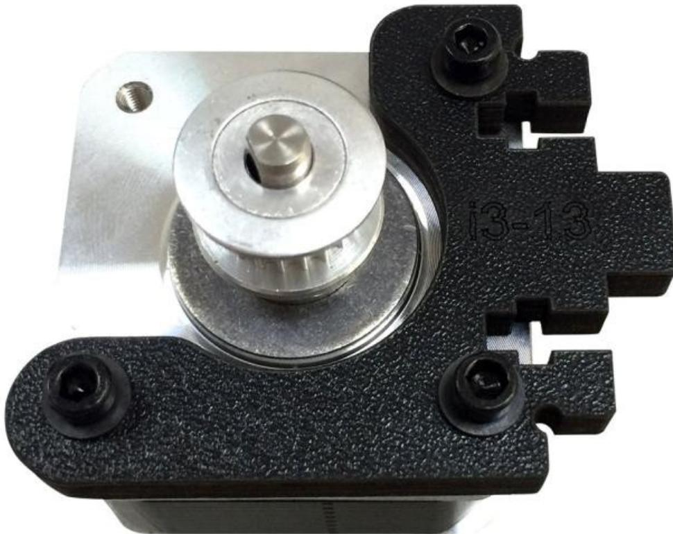
Étape 3. Placez le support du moteur de l'axe des Y dans l'orifice carré de la plaque arrière. Ensuite fixez-le à l'aide de 2 vis **M3x16mm** (NO.24), rondelles plates [**M3 Washers**] (NO.7) et écrous carrés [**M3 Square Nuts**] (NO.15).
