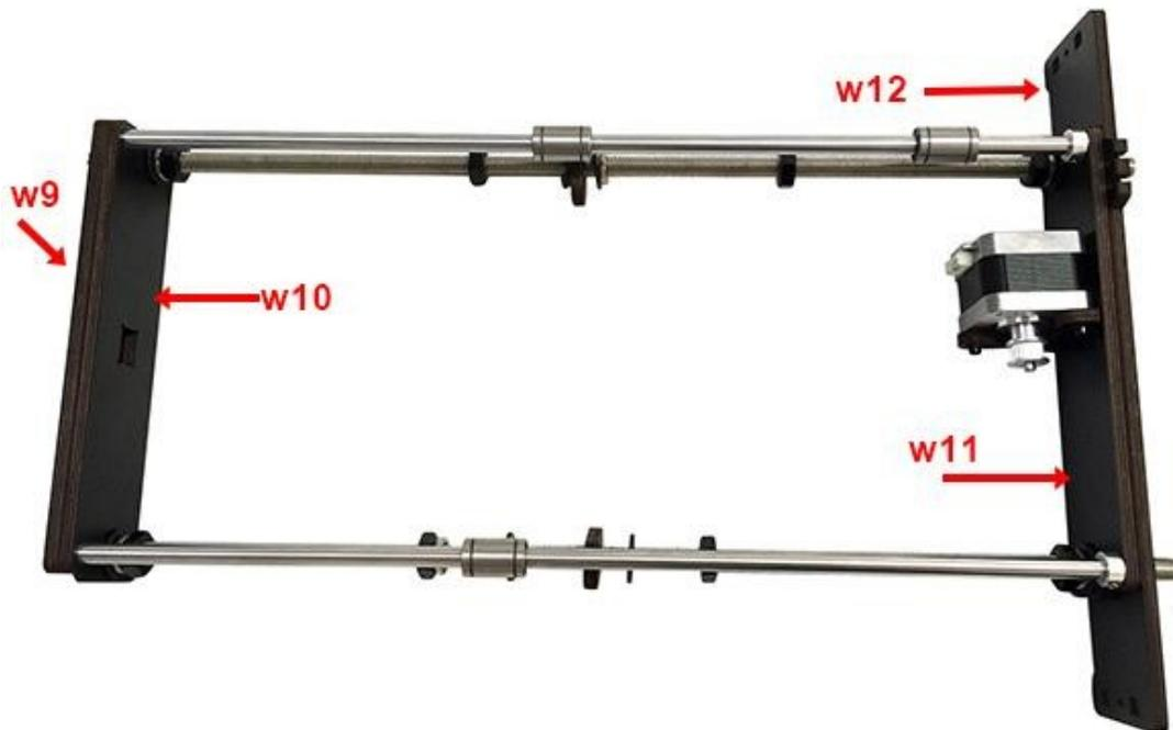
**\* Conseil: Efforcez-vous de garder les tiges filetées parallèles et de même les quatre pièces de bois parallèles. L'axe des Y doit être un rectangle, ce qui signifie que les tiges des deux côtés doivent être parallèles, de même que les plaques à l'avant et à l'arrière. Dans le cas contraire cela gênera le passage de la courroie de transmission. Mesurez les écartements avec précision, par exemple à l'aide d'un télémètre digital.**
