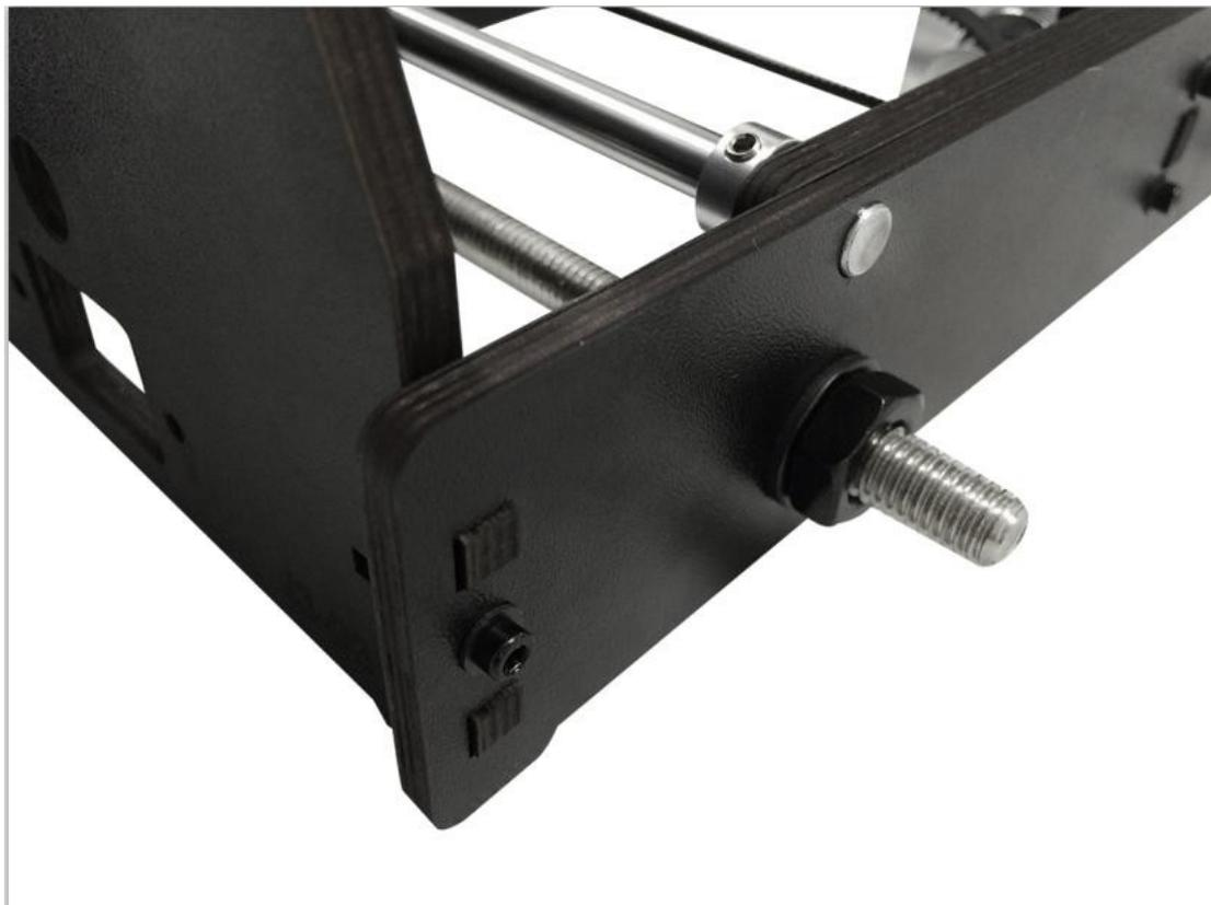
Étape 3. Vissez fermement le cadre principal à l'axe des Y à l'aide de 4 vis [M3 x 16mm screw](NO.24), de rondelles [M3 washer](NO.7) et d'écrous [M3 nut](NO.10).
