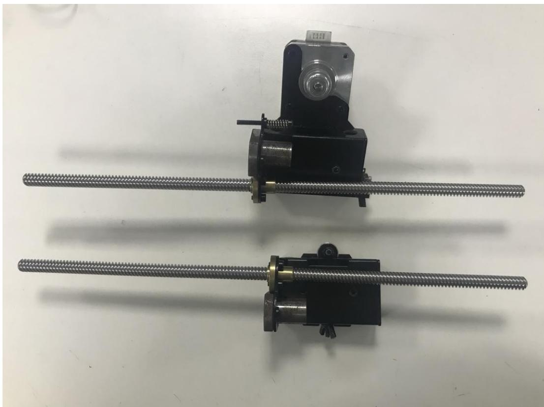
Étape 3 : Placez la tige filetée de l'extrémité du moteur X au couplage gauche du moteur de l'axe Z. Ensuite, glissez la tige lisse de 320 mm dans le support coulissant.
