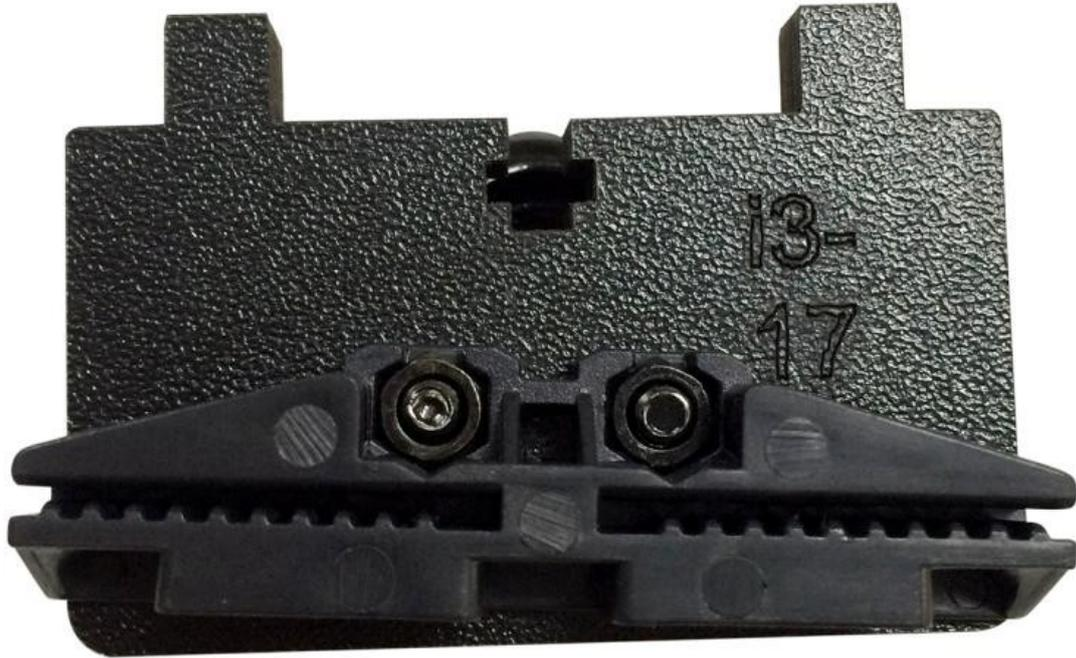
Étape 3. Montez the support de courroie [**belt mount**](NO.A17) sur [**Y platform support**](NO.W15) avec les vis [**M3 x 12mm screw**](NO.23), les rondelles [**M3 washer**](NO.7) et les écrous carrés [**M3 square nut**](NO.15) sur le même côté à l'aide du [**Y bearing block**](NO.W16).
